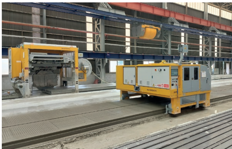
Plotter e Sega multi-angolare che lavorano in modo completamente automatico
