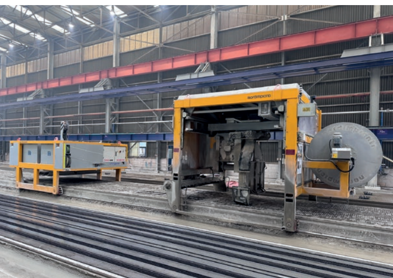
Sega multi-angolare automatica con carrello contrappeso
