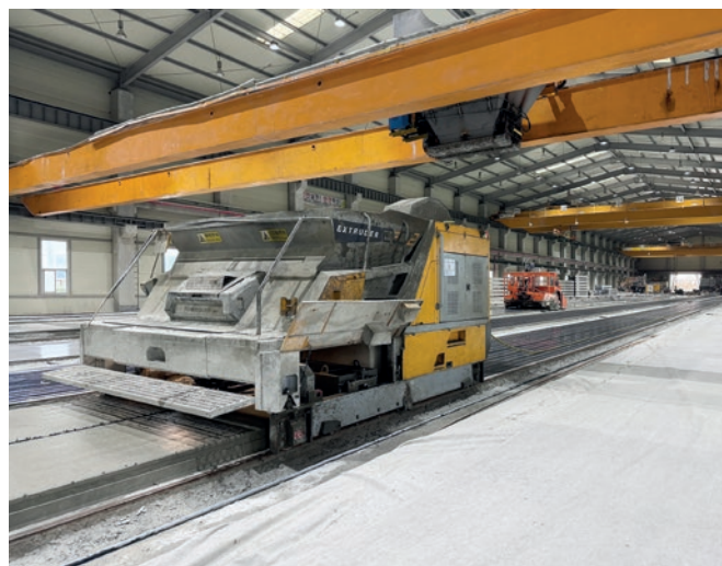
Extruder EVO2 a doppio pannello da 2,4 m durante la fase di getto
